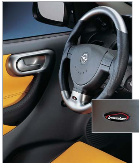
Stuurwielrand aluminium-look/leder i 71 18 105 (zonder geïntegreerde radiobediening), i 71 18 106 (met geïntegreerde radiobediening), deurgreepschalen in aluminium-look i 35 17 054/055/056/057.
