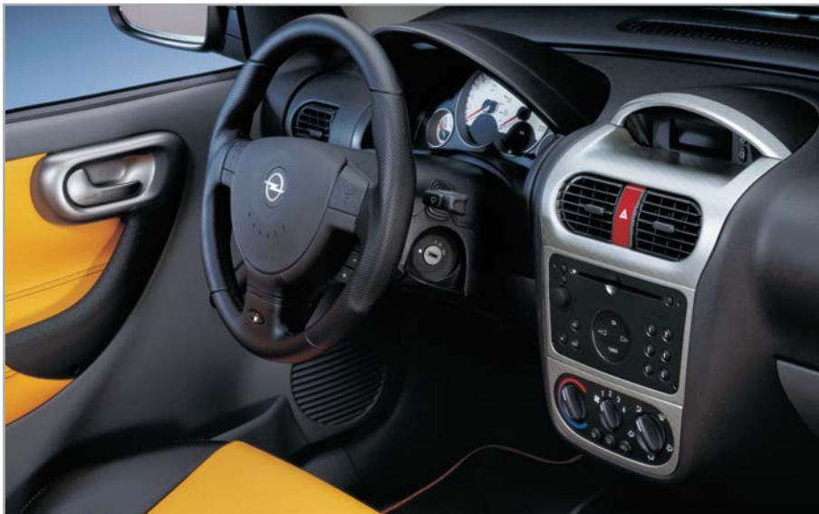
Stuurwielrand zwart leder, i 71 18 107 (zonder geïntegreerde radiobediening), i 71 18 108 (met geïntegreerde radiobediening). Interieur in aluminium-look, geborsteld, i 35 17 001, deurgreepschalen in aluminium-look i 35 17 054/055/056/057.
